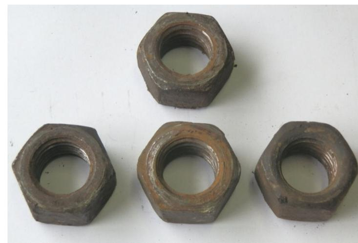
Образцы применения цинк-ламельного покрытия на крепеже
